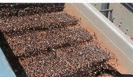
**SCHWUNGVOLL:** Transversalschwingungen befreien die Siebspalten von Steckkorn und Materialanhaftungen. Foto: Joest Internet
